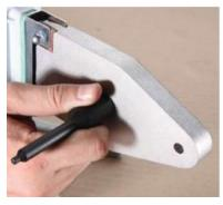
4.2.2. На греющую поверхность сварочного аппарата надеваются ремонтные насадки и закрепляются с помощью винтовой шпильки. Насадки навинчиваются на шпильки вручную.
